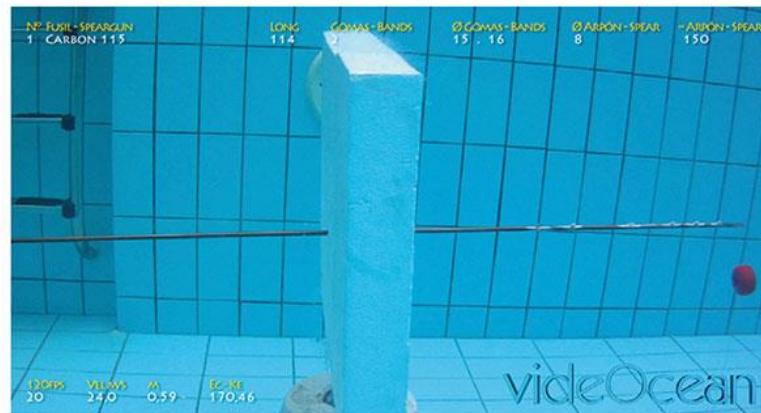
La penetración sobre la diana nos permite analizar precisión y potencia.
